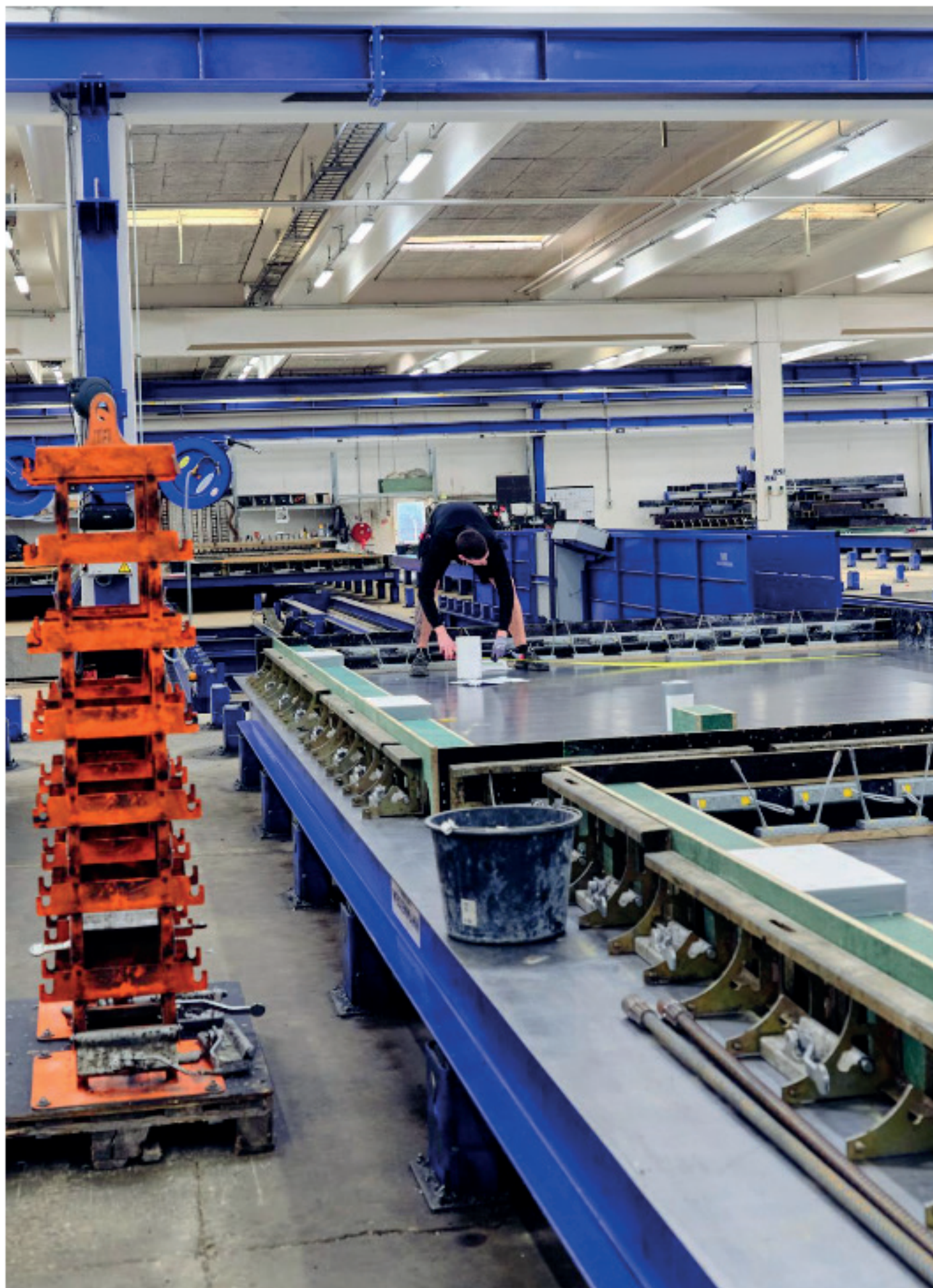
Industri Betons produktion i Svinninge er en af de mest moderne i Europa. Efter Lean-modellen er fabrikken opdelt i celler, og det er støbebordene, der flyttes rundt i fabrikkshallen i de forskellige faser af produktionen. Foto: Magnus Møller
