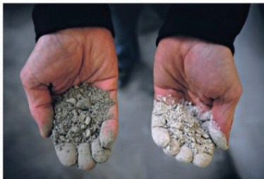
Dansk Betonindustri, der er et datterselskab til IBF, kan som de første herhjemme tilbyde betonelementer, hvor cementen er delvist erstattet af den langt mindre CO 2 -tunge slagge. Foto: Magnus Møller
