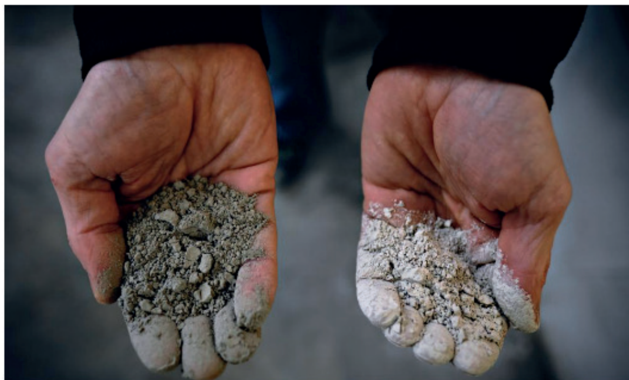
Carsten Greibe viser forskellen på den traditionelle cement og slaggen, der er noget lysere og en lille smule finere i strukturen. Magnus Møller
